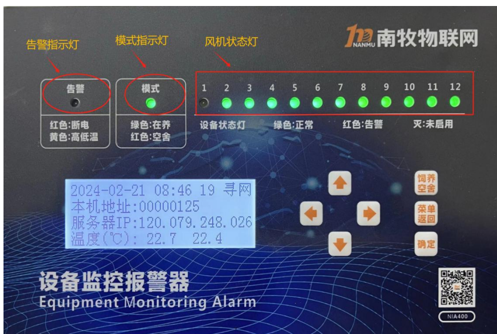
图一 风机检测系统操作面板
